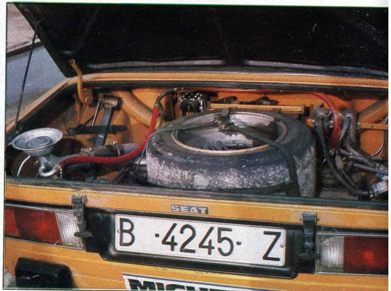
en las largas pruebas. En cuanto al regulador de frenada, éste está situado en la parte trasera izquierda del conductor, y metiendo el brazo se llega fácilmente a él, pudiendo accionarse según los gustos, para dar más preponderancia en la frenada a un tren o a otro. Normalmente, a Zanini le gusta tener bastante freno atrás, puesto que según él: "Si me paso y llego muy de prisa a una curva, pego una patada al freno, y al frenar más le culo, esto ayuda a que se meta el coche en la curva".
